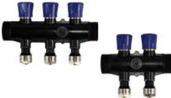
Válvulas de corte predispuestas para cabezal termoeléctrico. Derivaciones con conexión para bicono intercambiable para tubo multicapa, plástico y cobre. Entrada: 1-1/2" macho-macho. Distancia entre conexiones: 60 mm. Conexión: 3/4M EUROCONO
