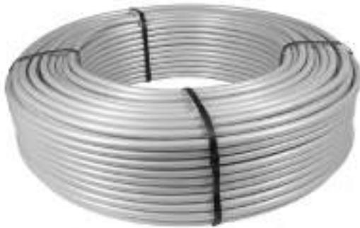
Tubo multicapa ALB SUPERFLEX gris para climatización radiante, 16x2, compuesto por una capa interior en polietileno PE-RT-I, una capa intermedia en aluminio soldada a testa, y una capa exterior en polietileno (PE-RT-I).
