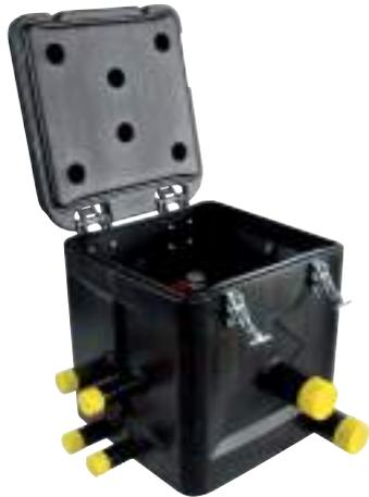
Arqueta para 2-4 sondas de geotermia con colectores incluidos. Completamente montada y lista para su colocación en obra. Fácil de instalar por un solo operario. Fabricada en PEHD (Polietileno de alta densidad), confiere al conjunto la robustez necesaria. Tapa transitable hasta 200kg.
