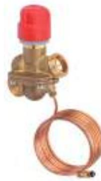
Válvula de presión diferencial combinada de equilibrado automático que incorpora un tubo capilar. Realiza 3 funciones: control de la presión diferencial del circuito al que abastece, control de zona y limitación de caudal. Admite el montaje de un cabezal termoelectrónico para su apertura y cierre.
