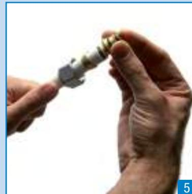
Introduzca el adaptador en el extremo del tubo; el conjunto está listo para montar.
