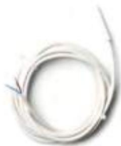
Sonda de pavimento para conectar mediante bus a la base de conexiones. Este accesorio opcional permite que la instalación deje de funcionar si detecta que la temperatura del suelo está por encima (calefacción) o por debajo (refrescamiento) del valor de seguridad consignado desde los termostatos ambiente o desde la aplicación móvil. Se recomienda cablear con par trenzado de sección mínima 0,6 mm<sup>2</sup> y no superar los 30 metros de longitud total.
