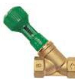
Válvula de equilibrado hidráulico de ajuste manual. Incorpora escala graduada de 0 a 8 posiciones. Función memoria en el pomo que permite mediante un tornillo fijar la posición de ajuste y recuperarla fácilmente si se manipula el mando.
