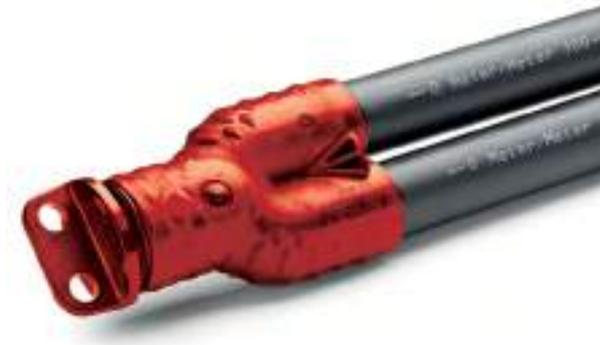
Las sondas geotérmicas de Polietileno de alta densidad (PE-RT) son de uso habitual y se encuentran ampliamente extendidas. La vida útil estimada de estas sondas para aplicaciones de sólo calefacción y para aplicaciones de calefacción/ refrigeración es de más de 100 años, siempre que la temperatura del fluido que circula en ellas no sea superior a 40°C. **Cabe mencionar que temperaturas superiores a 40°C no son habituales en instalaciones convencionales.**
