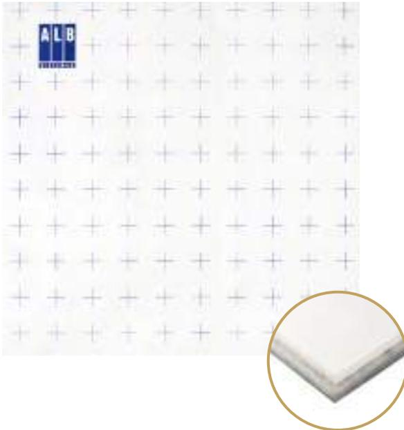
Panel aislante industrial ALB liso solapado, fabricado en poliestireno expandido (EPS), autoextinguible (Euroclase E) de 30 mm de grosor, cubierto por una lamina superficial de plástico provisto de solapas para unión entre paneles y cuadrícula de guía serigráfica.
