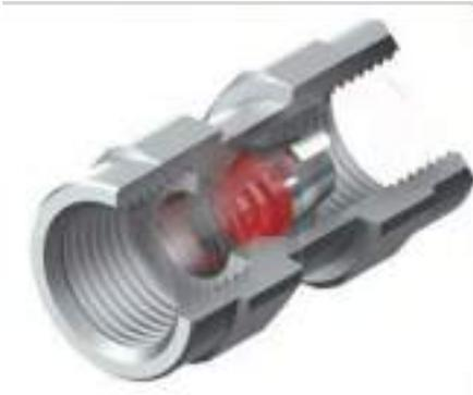
Dispositivo de seguridad térmica que bloquea el paso y evita las fugas de gas en la red de distribución en caso de incendio. Está diseñada para activarse entre 95 y 100 °C y su funcionamiento está garantizado hasta 925 °C durante una hora.
