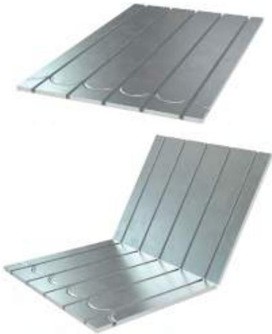
El panel aislante ALB con difusor en omega permite realizar trazados rectos en la zona central de la estancia y trazados curvos en los extremos de la estancia para el giro del tubo (diseño en serpentin). Dicho panel tiene canales en forma de  $\Omega$  para el adecuado encaje del tubo. Las canales rectas son claramente visibles y mientras que las canales para realizar el giro deben ser abiertas en obra según necesidades. Para ello es necesario cortar el difusor en omega mediante un cúter.
