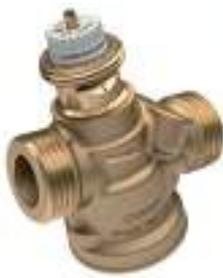
Válvula de equilibrado hidráulico dinámico que limita el caudal máximo de forma automática e independiente. Mantiene la presión diferencial a un valor constante una vez fijado un caudal en el volante. Admite el montaje de un cabezal termoelectrónico para su apertura y cierre.
