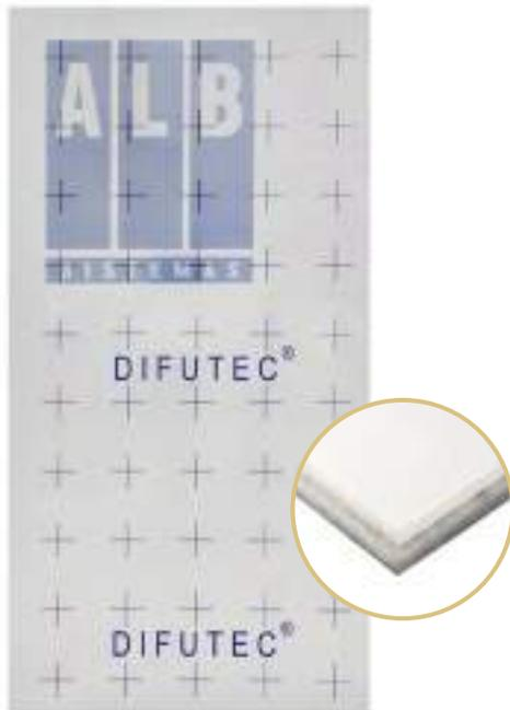
Panel aislante ALB-DIFUTEC®, fabricado en poliestireno expandido, (EPS) autoextinguible (Euroclase E), de 10 mm de espesor, cubierto por una lámina superficial de aluminio, difusora del calor provista de solapas autoadhesivas y cuadrícula de guía serigrafiada.
