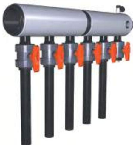
Colectores modulares fabricados en base a polietileno de alta densidad PE100 para conexión de sondas Ø40 (verticales) fabricadas en PE100 y con relación de diámetros SDR11. Conexión de dichas sondas mediante termofusión HS. Dotado de válvulas de bola. Incluye purgador R 1/2" y llave de llenado/vaciado. Dispone de dos orificios con rosca R1/2" con tapones para alojamiento de accesorios (p. ej. termómetro).
