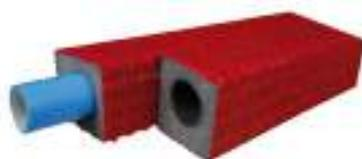
Coquilla aislante ALB de 25 mm de altura, fabricada en espuma de polietileno PE con un agujero excéntrico de 18 mm para el paso de tubos, corrugados o tubos multicapa.
