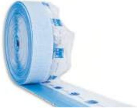
**Código 18690.** Banda de 150 mm de alto y 8 mm de espesor, fabricada en espuma de polietileno de celda cerrada; este material posee un coeficiente elástico adecuado para deformarse bajo la presión dilatométrica del mortero, y permitir su expansión sin que se produzcan efectos adversos en la construcción.
