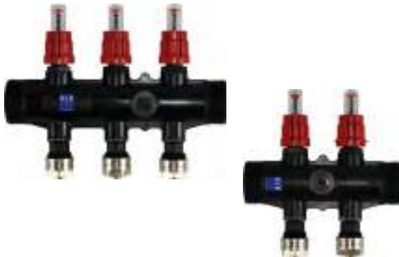
Caudalímetros reguladores de caudal para el equilibrado de circuitos. Derivaciones con conexión para bicono intercambiable para tubo multicapa, plástico y cobre. Entrada: 1-1/2" macho-macho. Distancia entre conexiones: 60 mm. Conexión: 3/4M EUROCONO
