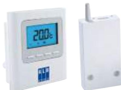
Kit compuesto por un termostato calefacción/refrescamiento y un receptor inalámbrico. Conjunto diseñado para funcionar de forma autónoma: el receptor dispone de una salida on/off para cablear directamente a una válvula de zona, a un arranque/paro de bomba o a una fuente de calor en función de la señal del termostato. Es posible proporcionar control remoto vía internet añadiendo la pasarela ALB código 23420. El receptor de este kit no es compatible con la base de conexiones ALB.
