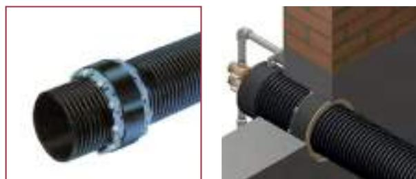
Uso: elemento estanco al agua para paso de la tubería preaislada ALB a través de muros que asegura el sellado en caso de agua presurizada. El sistema de sellado se basa en una serie de uniones que se expanden para ejercer presión contra el muro al atornillar los tornillos.
